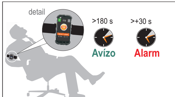
obr. 3 - detekce osoby bez pohybu pomocí mobilu
